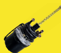
BZ 0545 20" x 24" / Baioneta Haste longa 320mm / Port. 16 x 1,5 c/ adp. p/ 22 Voss / Entre parafusos 120mm 9254300470/9254300480 1446033 / 1446040
