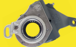
MB AXOR L / LK / LS ACTROS 2546 / TRAS LE L1633 ACTROS 4844K / 4144 / 26 estrias ABA / Posição traseira
