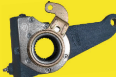
MB ATEGO 2426 / 2429 1726 / 2425 / ATRON 2324 ACTROS 2546 / 26 estrias ABA / Posição traseira
