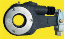
Carretas (todas) VW / Iveco / DAF / Ford / AA315 / 91828 / 28 estrias Com forquilha Posição dianteira e traseira
