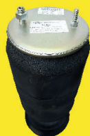
Carretas Facchini até 2005 2 parafusos rosca M18x2,50 e M12x1,75
