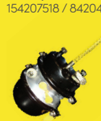
BZ 0015 Tampa BZ 1051 30" x 30" / Carreta Universal / Haste longa 305mm / Port. 16 x 1,5 Entre parafus. 120mm 7901
