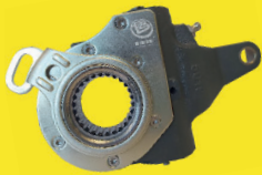
MAN TGX 28440 / 29440 3º eixo ABA / 26 estrias 2º eixo MB 1619 / 1615 Posição traseira
