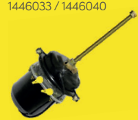
BZ 0913 30" x 24" / Tristop Haste longa 345mm Tração Port. 16 x 1,5mm Volvo/MB/ Scania/Iveco Entre parafusos 120mm 884 502 755 0
