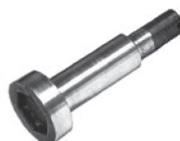
Pino do braço tensor Randon, rosca 1"x14fpp - GGG50 (cabeça 70mm / corpo 38x90mm).
